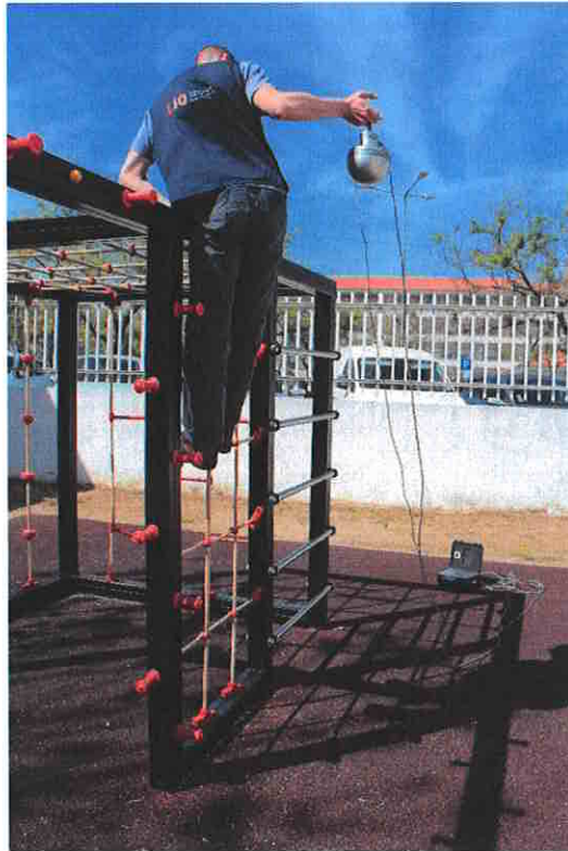
Figura 73 Realização de Ensaio HIC, (NP EN 1177 - avaliação da capacidade de amortecimento dos pisos), Critério relativo a traumatismos cranianos causados por quedas)
