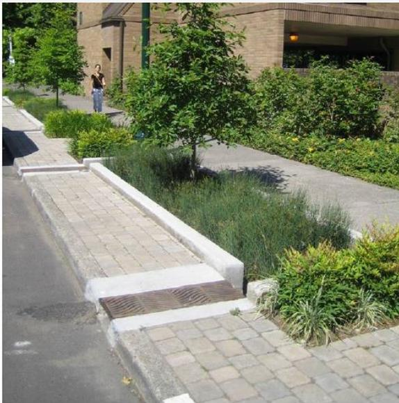
Canteiro pluvial de passagem ou absorção de água
